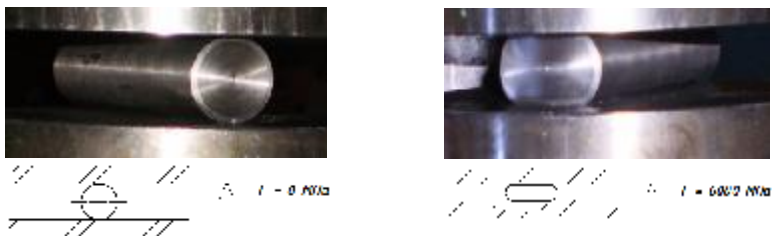
Рис. 1. Схема поперечного холодного деформування (ХПД)
